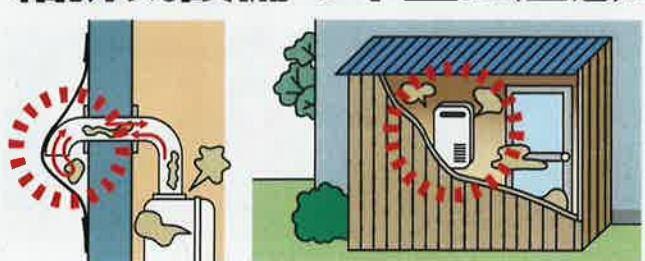
外壁の塗装時に養生シートで給排気設備をふさいだり、屋外式の燃焼器を波板等で囲むと、燃焼器から発生したCOが室内に滞留し、CO中毒の原因になります。
