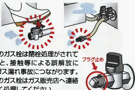
未使用のガス栓は閉栓処理がされていないと、接触等による誤解放によってガス漏れ事故につながります。未使用のガス栓はガス販売店へ連絡し、正しく処理してください。
